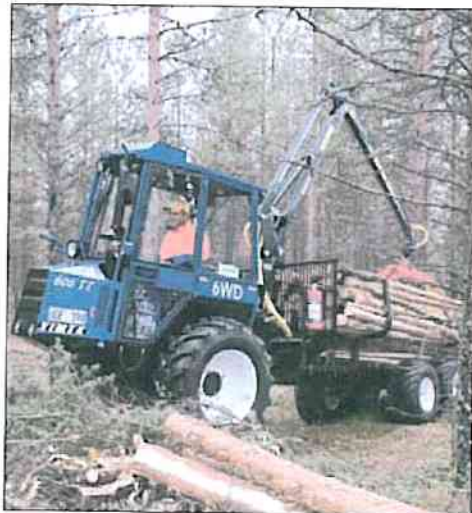
Vimek 606TT har vist sig at have 75 procent lavere brændstofforbrug end traditionelle skovningsmaskiner.
