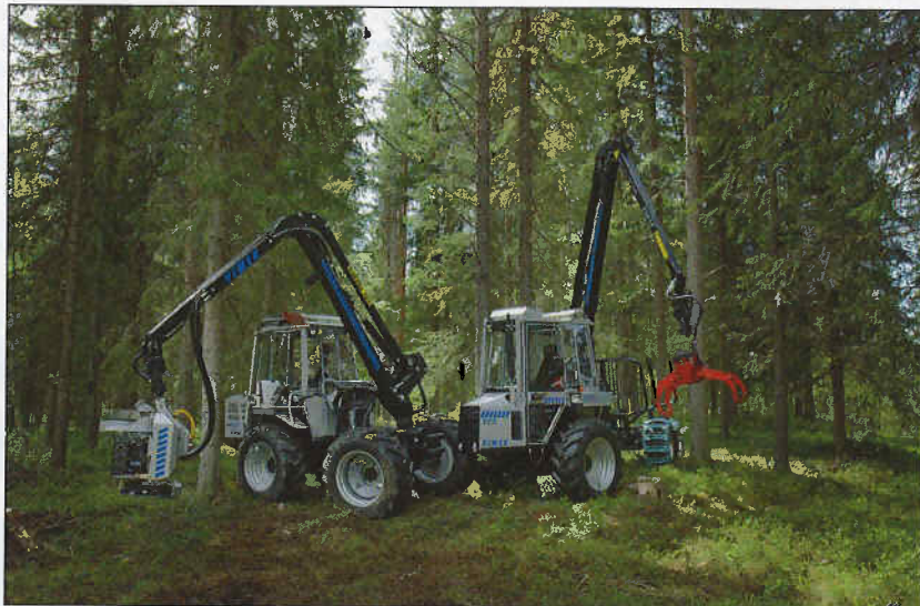
Lekki, łatwy w manewrowaniu i efektywny Vimek 404 T w połączeniu z forwarderem Vimek 608 może stanowić kompletny zestaw maszyn trzebieżowych bez konieczności zakładania szlaków. Wszystkie zdjęcia: arch. OTL Jarocin
