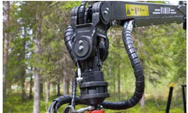
Patentoitu oma jarruriipuke. Hallitaan hydraulisesti ja täysi voima kaatokatkaisussa. Perusäättö mekaanisesti.
