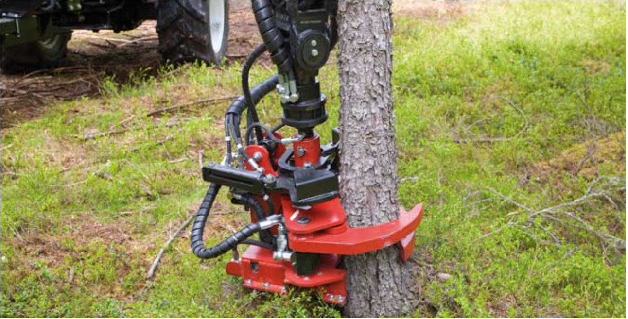
Suurin katkaisuläpimitta: 160 mm. Työpaine 200 Bar. Suositeltu öljyntuotto 35 l/min. Paino 150 kg. Aukeama 670 mm. Katkaisuvoima 8.000 kg.
