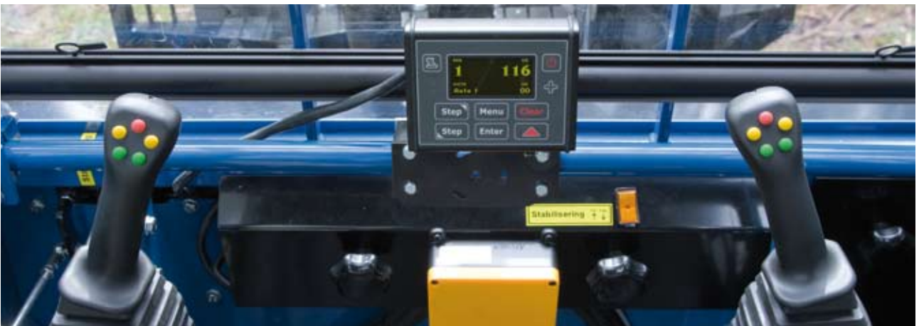
TB160 punnitusjärjestelmä on saatavissa lisävarusteena energiakouraan. Järjestelmä punnitsee painon kourassa kuormaa purettaessa.
