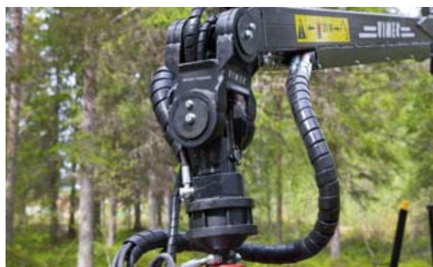
Opatentowany amortyzator kołysań, sterowany przez hydraulicznie; pełen efekt w pozycji złamanej. Mechaniczna regulacja.
