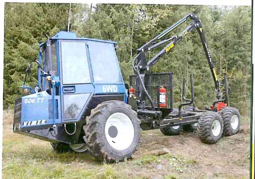
Unten rechts: Der Vimek Forwarder 606 TT ist wie der Harvester nur 1,80 Meter breit und damit die ideale Ergänzung zum 404 T. Unten links: In den schmalen Rückegassen ist der Vimek Forwarder ganz in seinem Element.
