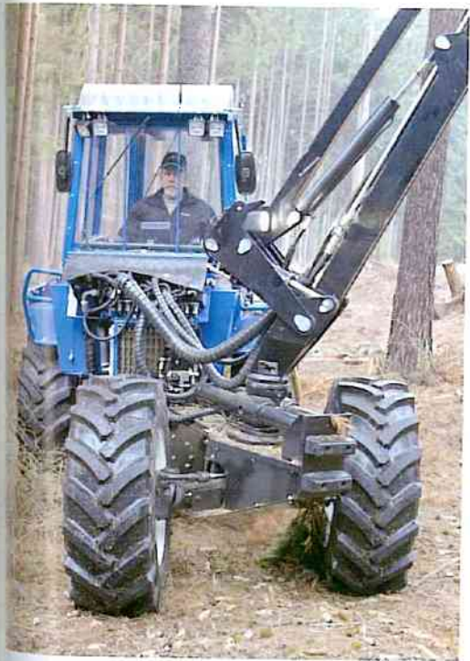
Unten rechts: Der Vimek Forwarder 606 TT ist wie der Harvester nur 1,80 Meter breit und damit die ideale Ergänzung zum 404 T. Unten links: In den schmalen Rückegassen ist der Vimek Forwarder ganz in seinem Element.
