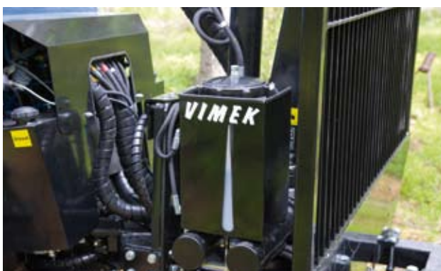
Mechanizm grzybobójczy. Unikatowe rozwiązanie zintegrowane z chwytakiem kombi Vimek 160.
