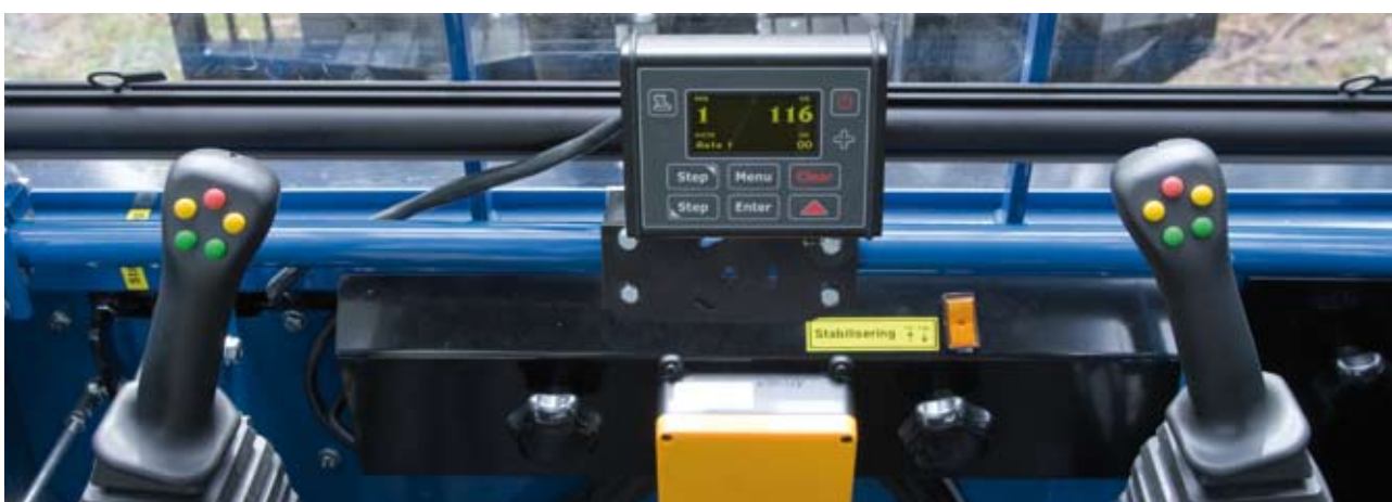
System pomiaru wagi zintegrowany z chwytakiem kombi dla bezpiecznego i poprawnego działania. System dokonuje pomiaru wagi na chwytaku kombi i rejestruje dane w dołączonym komputerze.
