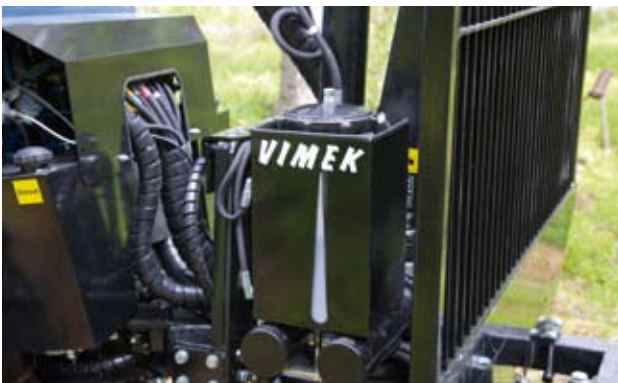
Stubbehandling/Rotstopp. Unik lösning på klippaggregat att behandla stubbar med Rotstopp vid uttag av klenräd.
