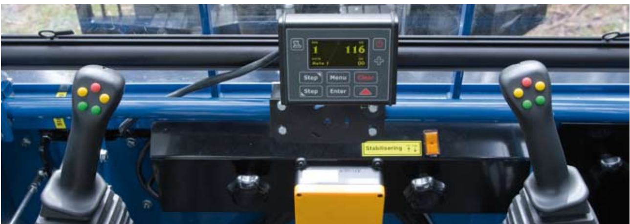
Wiegesystem TB160 ist sicher im Aggregat integriert. Es registriert das Gesamtgewicht der kompletten Fällung.
